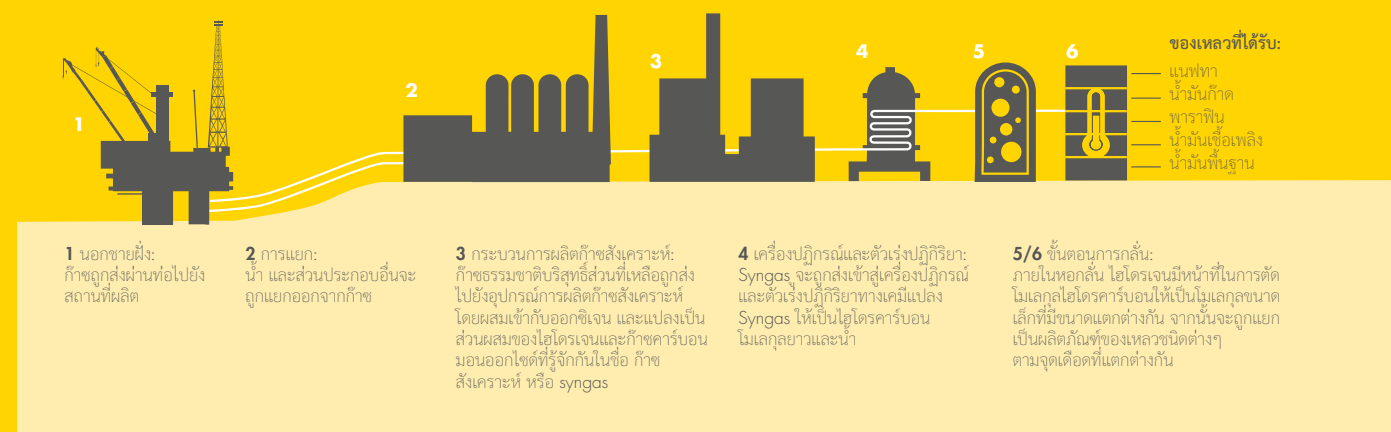
รูปที่ 2: กระบวนการ GTL เปลี่ยนก๊าซธรรมชาติที่แก๊สอย่างสะอาดเป็นเชื้อเพลิงสะอาด และน้ำมันพื้นฐานที่มีคุณภาพสูงโดยผ่านกระบวนการ Fischer-Tropsch
